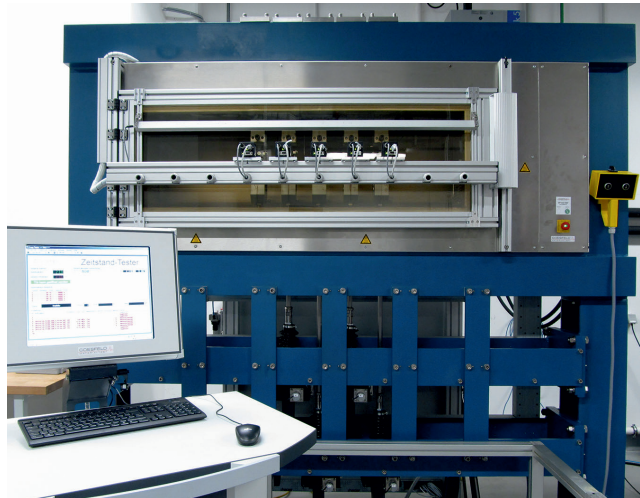
Bild 1. Motorische Zeitstandapparatur am SKZ zur zeitraffenden Ermittlung des Kriechverhaltens © SKZ
